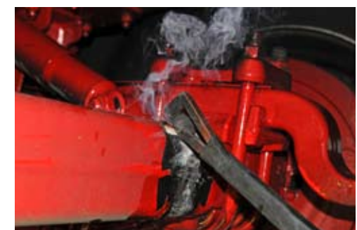
Inductietechniek zorgt voor lokale verwarming van de as.
