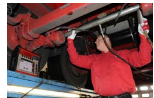
Met een hydraulische stempel worden de wielen recht gezet.
